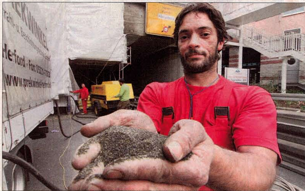
Im vor dem Staub sicheren Bereich außerhalb des Ringtunnels zeigt Marco Giovannetti die feinkörnige Hochofenschlacke.
